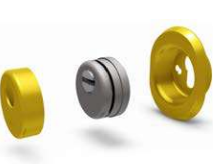
Defender Antishock. A protezione del cilindro in acciaio carbonitrurato e zinco tropicalizzato con piastrina anti strappo in lamiera imbutita. Adatto a resistere alla presa e alla rottura con il tubo innocenti.
