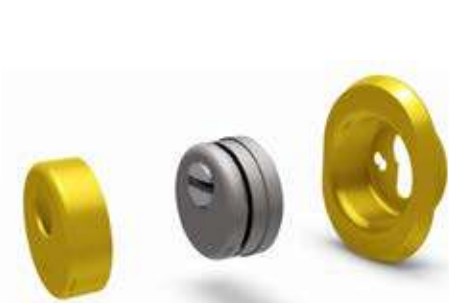
Defender Antishock. A protezione del cilindro in acciaio carbonitrurato e zinco tropicalizzato con piastrina anti strappo in lamiera imbutita. Adatto a resistere alla presa e alla rottura con il tubo innocenti.
